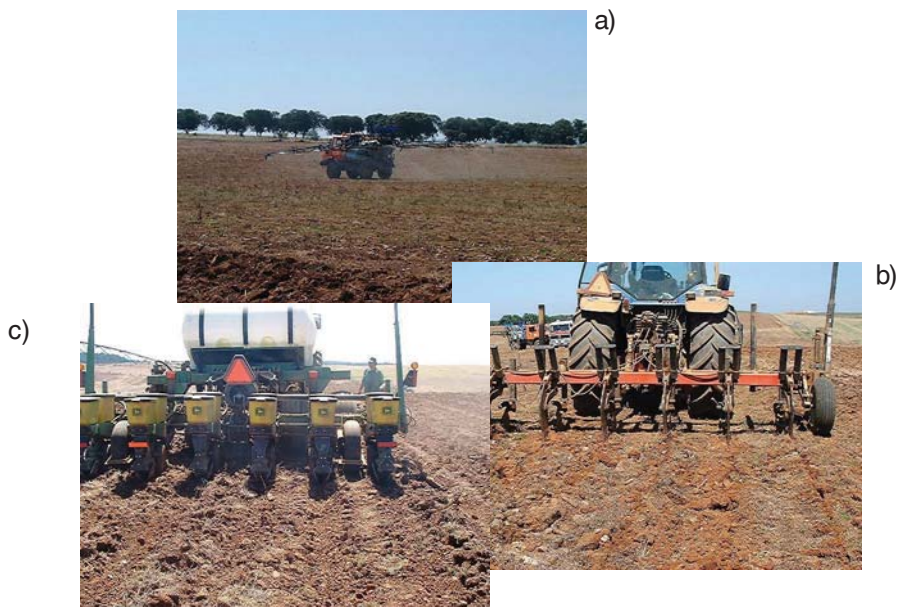
Figura 6 - Os sistemas de Mobilização na Zona obedecem à seguinte sequência: a) aplicação de um herbicida de pré-sementeira ; b) mobilização do solo na linha de sementeira (na fotografia, a realização de uma subsolagem poderá prender-se a razões estruturais do solo (necessidade de fendilhar uma camada compactada) e/ou garantir um melhor desenvolvimento das raízes das culturas mais sensíveis (e.g. girassol)); c) sementeira (na fotografia, realiza-se em simultâneo a aplicação de um adubo líquido).
