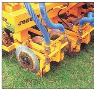
Figura 18 - Distribuição de chorumes à superfície (Esq.). Órgãos para injectar chorumes (Dta.).
