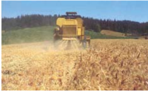
Figura 9 - Ceifeira equipada com traçador e distribuidor de palha (Esq.). Restolho de um cereal de Inverno sobre resíduos de milho(Dta.).
