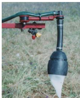
Figura 12 - Aplicador de espuma (Esq.). Falha na aplicação do herbicida em pré-sementeira (Dta.).
